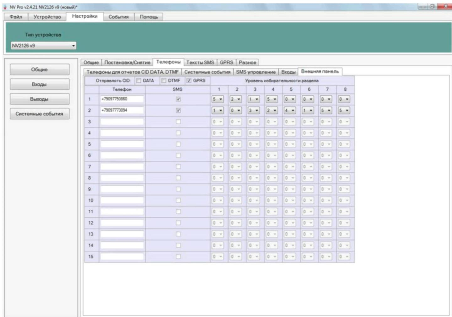
**Рис. 6.1** Настройка передачи отчетов от внешней панели
