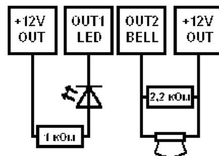
При подключении светодиодной индикации рекомендуется, согласно схеме справа, включать в цепь подключения резистор 1 кОм, для звуковой индикации – резистор 2,2 кОм (см.п.6.6).
